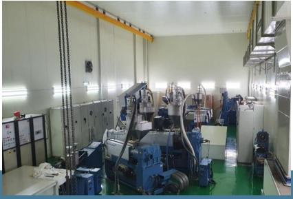
25kV高壓電纜押出機
