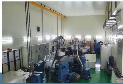
25kV高壓電纜押出機
